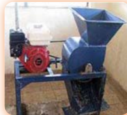
Photo 46 : Râpeuse de manioc motorisée avec tambour en acier inoxydable
