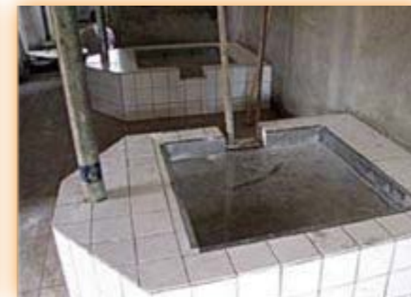
← Photo 50 : Une aire de grillage de gari avec un plateau d'acier inoxydable peu d'acier inoxydable profond ou récipient en aluminium moulé. Le plateau doit être monté
