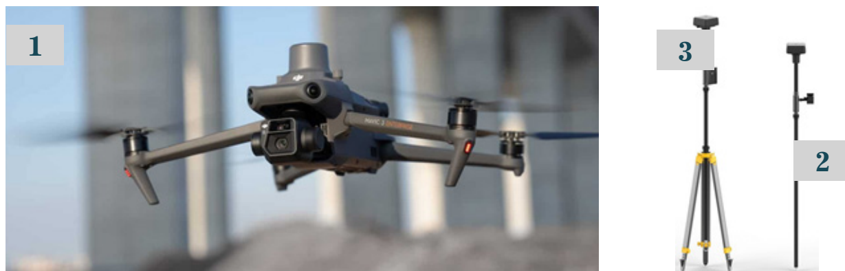
Figure 6. Présentation du drone DJI Mavic 3 Enterprise avec: le module RTK (1), le module D-RTK 2 monté sur sa tige (2) et sur sur un trépied (3) (Source : https://escadrone.com/produit/dji-mavic-3-enterprise/ )
