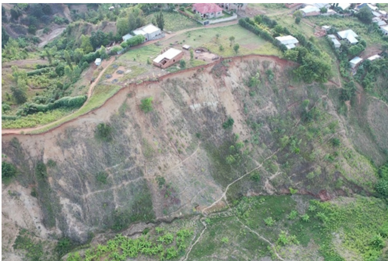
Figure 3. Photos montrant des constructions érigées à la tête des glissements de terrain à Mugoboka
