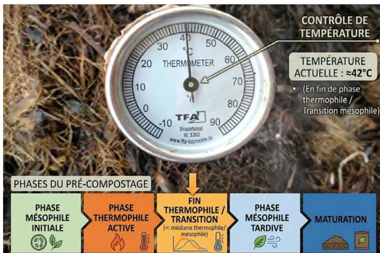
Figure 5.2. Suivi de la température dans les déchets de palmier à huile en fin de phase de pré-compostage.
